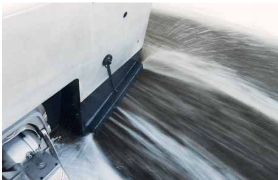
Trimovací klapky Zipwake zajišťují stabilitu jen s minimem odporu.
