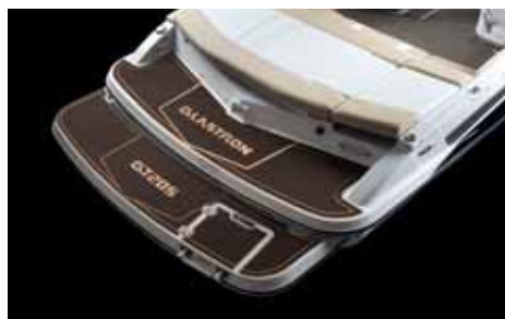
Zajímavým prvkem je dvoustupňová koupací plošina s protiskluzovým povrchem.
