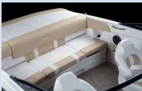
Zde je dobře vidět variabilita uspořádání kokpitu. Pod sedačkou je box o objemu 40 litrů, s odtokem vody tak, aby se dal naplnit ledem před odjezdem na celodenní výlet.
