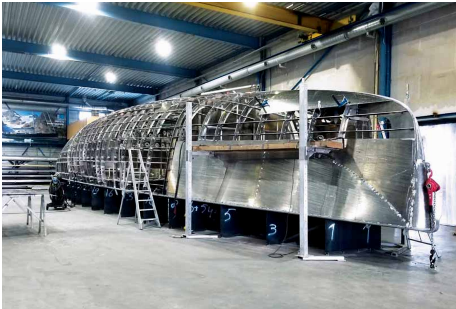
Na konstrukci trupu je dobře patrné, jak hustá jsou podélná i příčná žebra.
