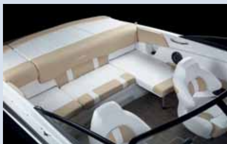
Zde je dobře vidět variabilita uspořádání kokpitu. Pod sedačkou je box o objemu 40 litrů, s odtokem vody tak, aby se dal naplnit ledem před odjezdem na celodenní výlet.
