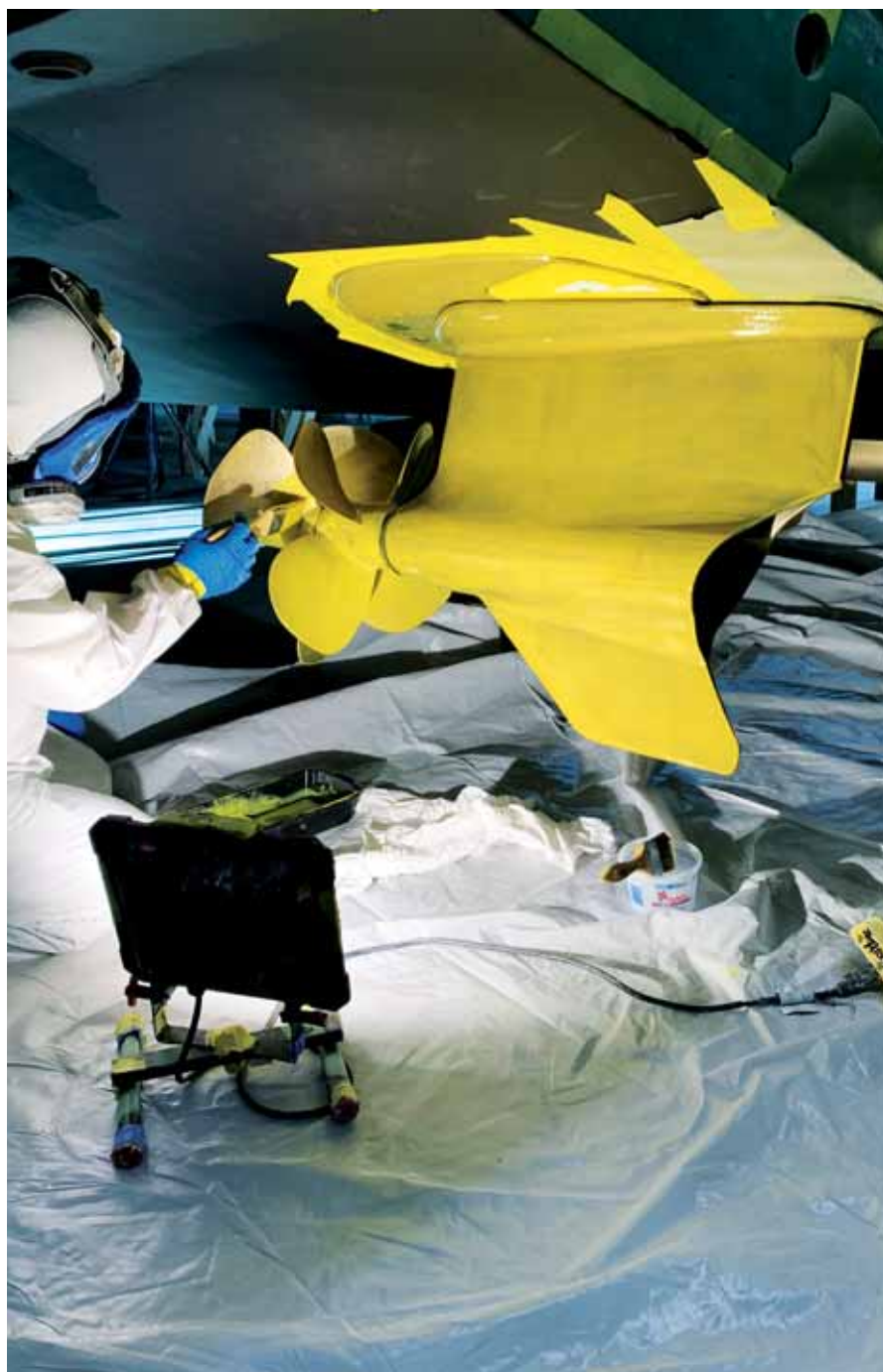
Aplikace nátěru Prospeed pro zmenšení odporu při vyšších rychlostech
