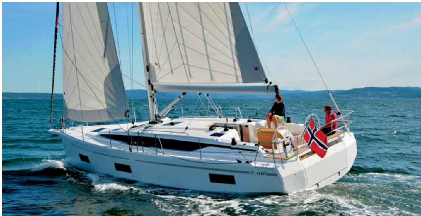
Z tohoto pohledu jsou dobře vidět svislé spíry na plachtě Elvström s triradiálním stříhem, které lze objednat za příplatek. Tyto plachty mají výrazně vyšší výkon a smazávají rozdíl mezi klasickou plachtou a plachtou rolovanou do stěžně.
