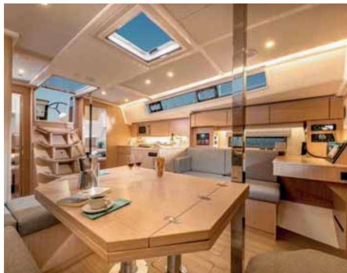
Stůl v salonu se dá nejen rozložit, ale také spustit dolů a vytvořit další lůžko.
