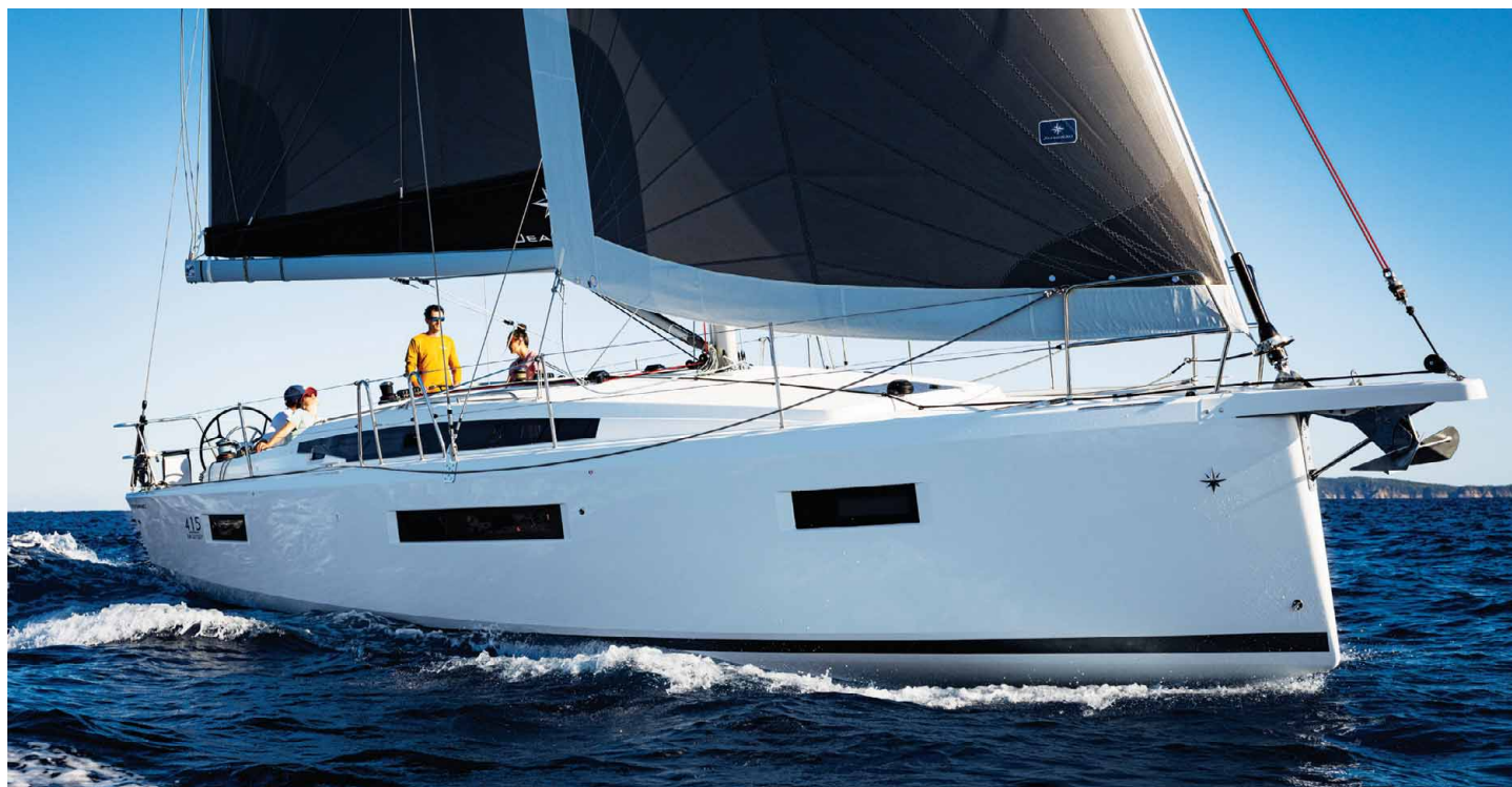
Negativně skloněné přídi dominuje čelen, pod kterým je uložena kotva.
