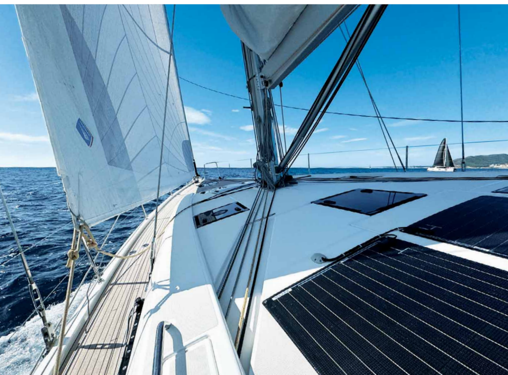
Na palubě jsou instalovány dva solární panely pro udržování akumulátorů v kondici.
