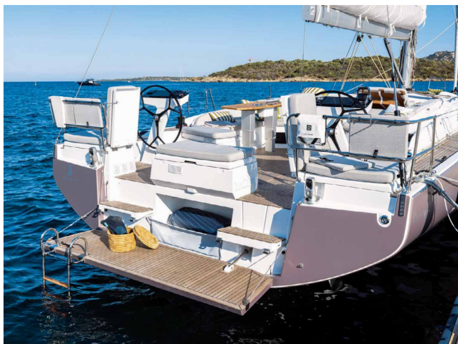
Koupací plošina na zádi. Po stranách jsou vidět zasunuté jeřábky na pomocný člun.
