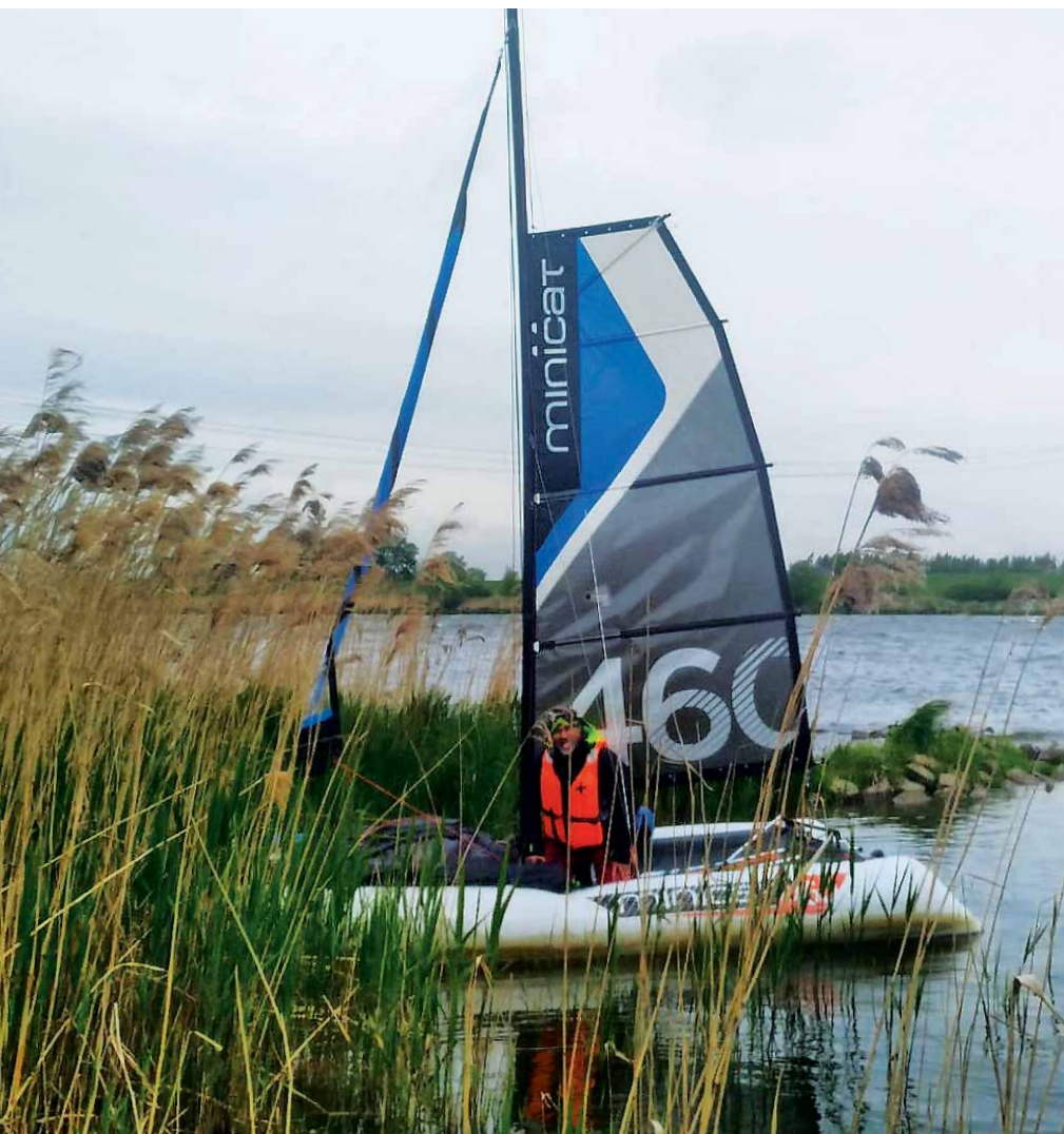
Jednou z úprav katamaranu bylo refování hlavní plachty. Plochou je přibližně poloviční. Velmi se nám hodila nejen při závěrečném refování v rákosí.
