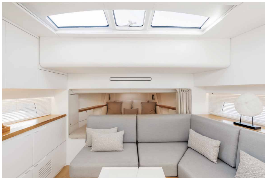
Přední kajuta nemá pevné dveře ani přepážku. Opět především kvůli úspoře hmotnosti.
