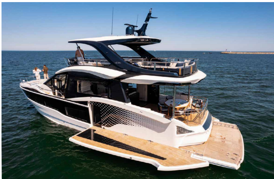
Sklopení levého boku umožňuje přímý výstup z majitelské kajuty na soukromou pláž a koupací plošinu.
